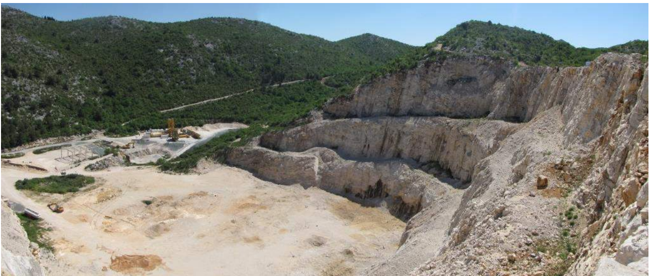
Slika 6. Postojeće stanje - formirane etaže
